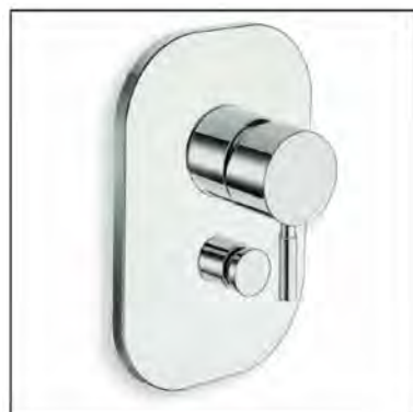
Miscelatore monocomando doccia a parete, piastra in ABS, con miscelazione meccanica, deviatore automatico a 2 uscite, completo di parte incasso
